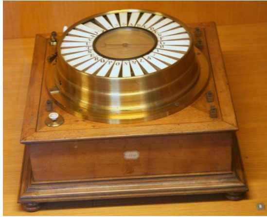
Récepteur télégraphique Siemens et Halske 1850
