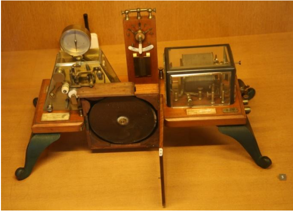
Récepteur télégraphique électro-chimique de Pouget-Maisonneuve, 1854
