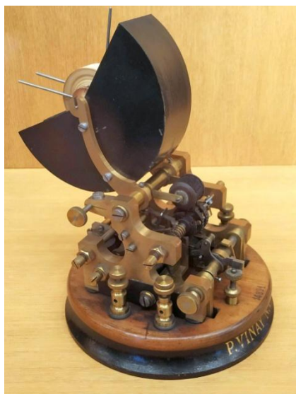
Appareil imprimant d'Higgins Universel stock ticker Télégraphe boursier américain de Western Union
